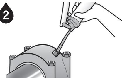
À l'aide d'un graisseur manuel, s'assurer que la voie de passage de la graisse est libre. **Note 1** Éliminer la graisse durcie en purgeant le point de graissage à l'aide d'un graisseur manuel. **Note 2** La graisse de l'appareil ainsi que la graisse contenue dans le dispositif de lubrification doivent être identiques ou compatibles.
